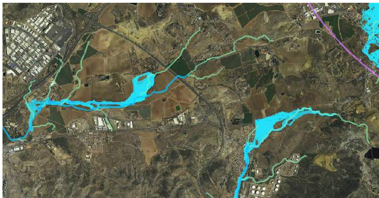
Calados para T=500 años de periodo de retorno en alternativas 1 y 4. Fuente: elaboración propia y SITMurcia
