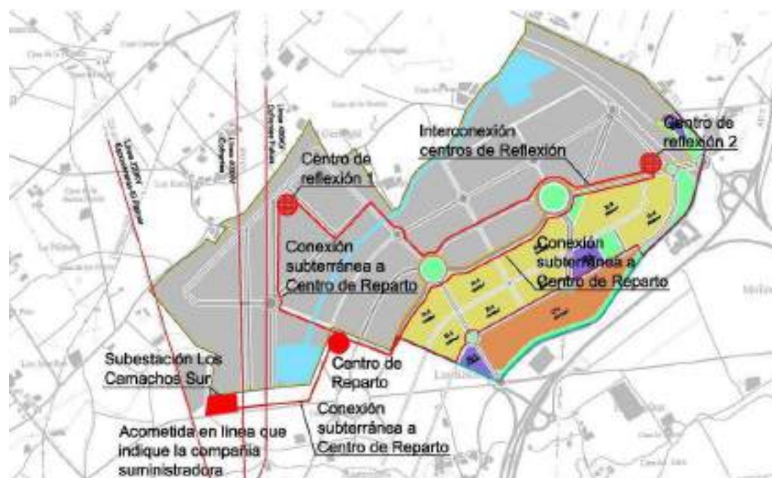
Suministro eléctrico en Alta Tensión. Fuente. Estudio de Viabilidad. UTE TRN-GETINSA-PAYMA
