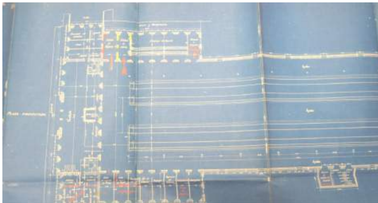
Fig. 84. Plano con las modificaciones efectuadas en la distribución interna de los andenes laterales antes del inicio del servicio, 11 de marzo de 1906, en "Modificación del proyecto de estación". AHF-MFM. C - 0963 - 002-2:5.
