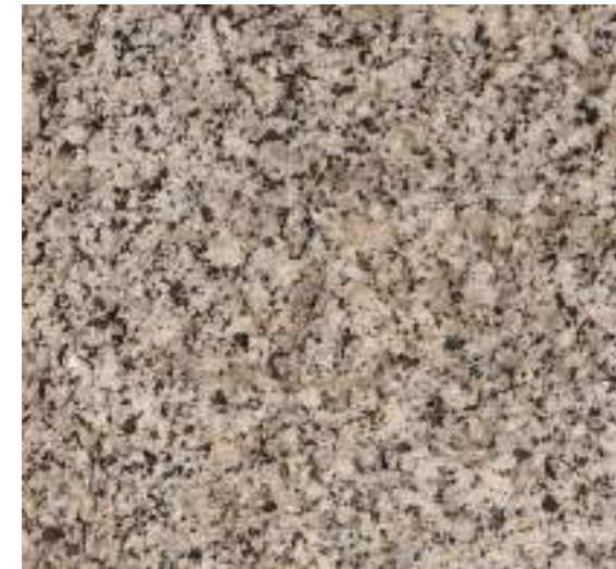
▲ Aspecto macroscópico de la piedra de granito de Don Benito del edificio de viajeros.
