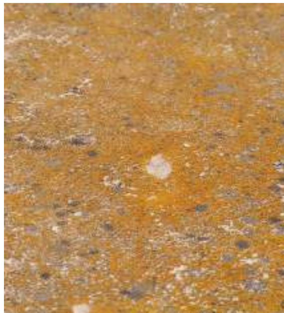
▲ Imagen tomada por microscopia electrónica de barrido de la muestra PC1 donde se ve la pátina biogénica bajo el revestimiento beige.
