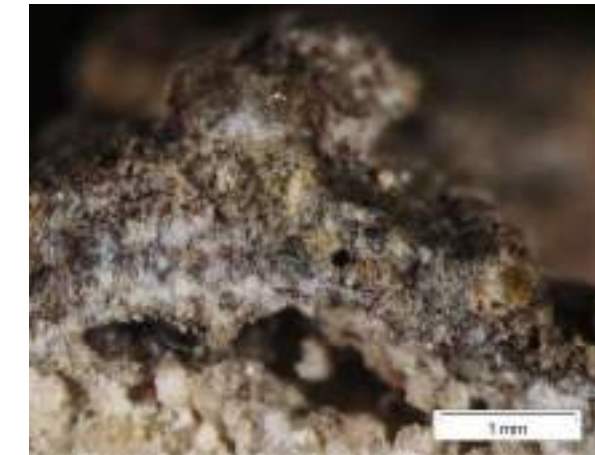
▲ Imagen tomada por microscopia electrónica de barrido de la muestra PC1 donde se ve la costra negra.
