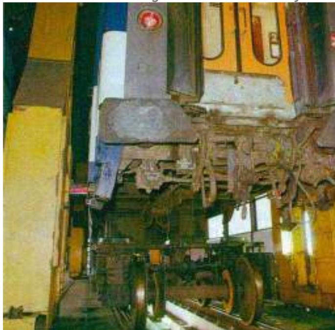
3.c. Cambio automático de ancho de vía de un vehículo o de un grupo de vehículos sin que cambien sus ejes o bogies, variando únicamente la distancia entre las ruedas. Este sistema se aplica en España desde 1969.
