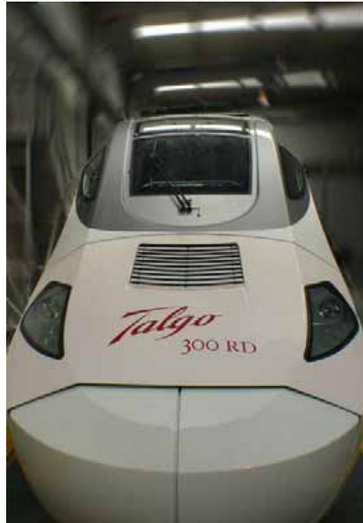
Cabeza motriz del prototipo de Talgo de ancho variable capaz de alcanzar los 300 km/h.
