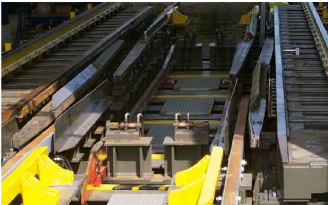
Cambiador de pruebas TCRS3 en posición CAF. Obsérvese que han bajado las guías rojas de encajeamiento Talgo y se han retirado lateralmente los carriles de apoyo.
